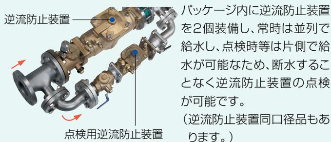
パッケージ内に逆流防止装置を2個装備し、常時は並列で給水し、点検時等は片側で給水が可能のため、断水することなく逆流防止装置の点検が可能です。
