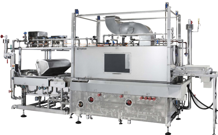
写真：ボイル冷却槽装置
