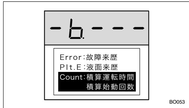
1号機の積算運転時間と積算始動回数が表示されます。
