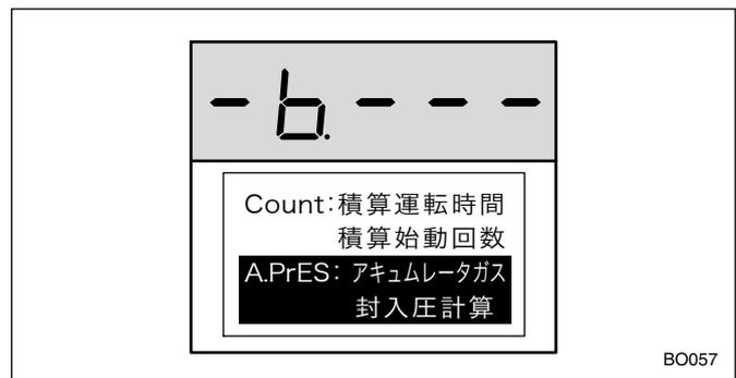
アキュムレータガス封入圧計算が自動的に計算され、数値が7セグメントモニタに表示されます。
