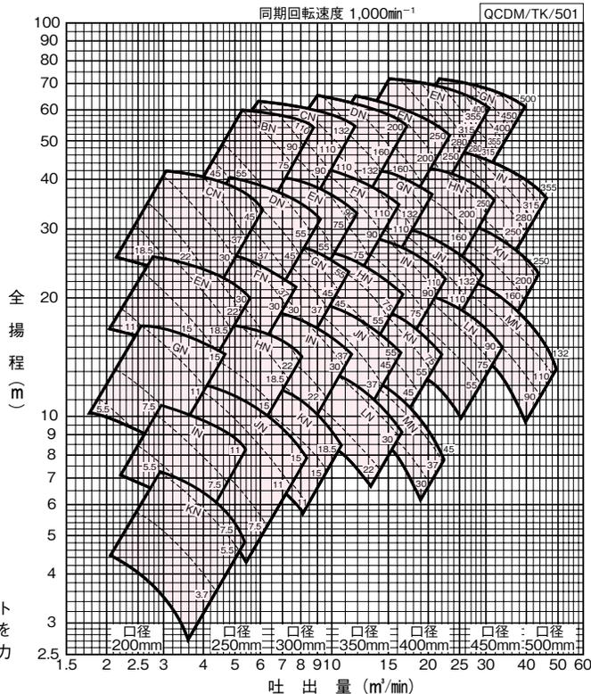
図中のアルファベットはケーシング記号を表し数字はモータ出力kWを表します。
