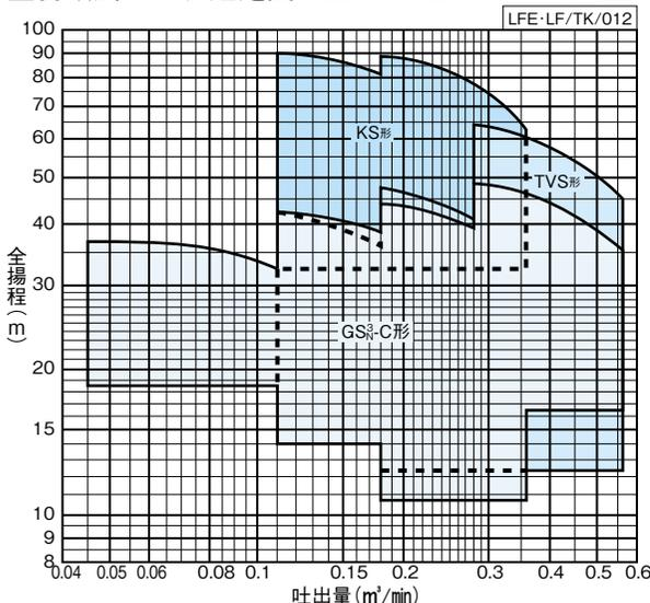
■各組合せポンプ適用図の性能曲線から、図1に従って、各損失抵抗を減じてユニット仕様を検討ください。
